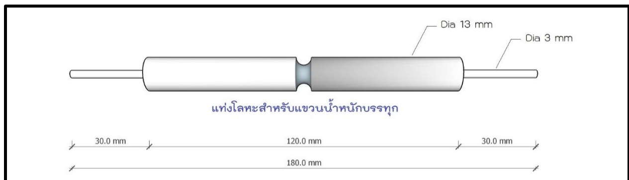
รูปที่ 1 แท่งโลหะสำหรับแขวนน้ำหนักบรรทุก (หน่วยมิลลิเมตร)
